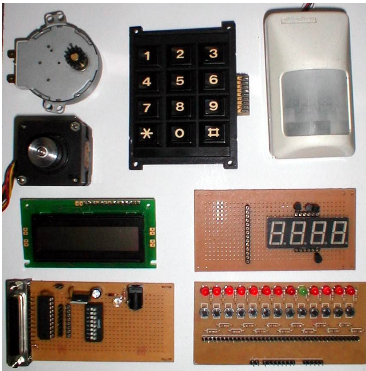
Figura 12: periféricos do kit didático de microcontroladores
